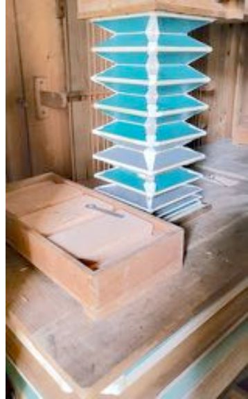
Das Gebläse. Ein sogenannter „Handorgelbalg“ führt den Wind vom Magazin zur Windlade.
